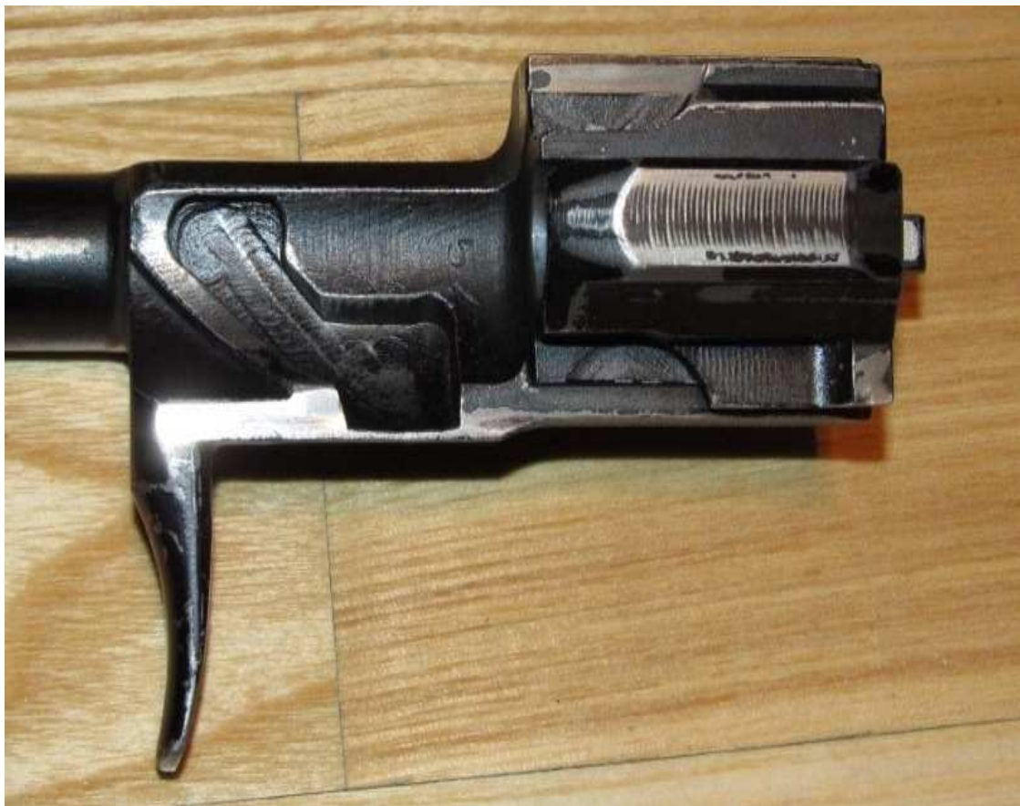
Rysunek 6: Suwadło z widocznymi miejscami pracy frezarki.
