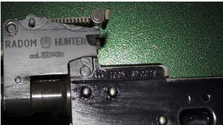
Rysunek 3: Radom Hunter - orzełek, nazwa broni, oznaczenie producenta, rok produkcji, numer seryjny
