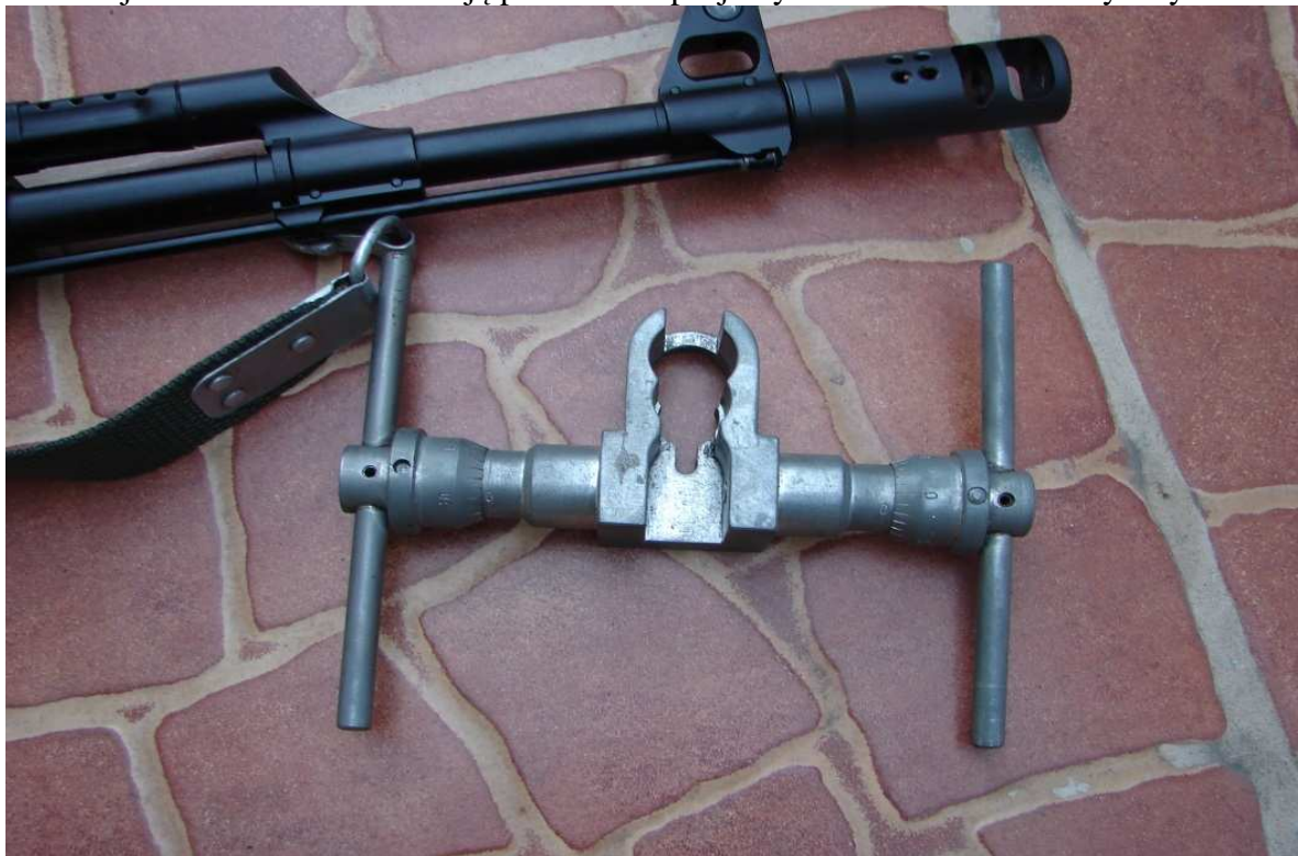
Mikrometryczny klucz do przestawiania muszki wyprodukowany w ZM Łucznik w 1998r ( własność autora tekstu).
