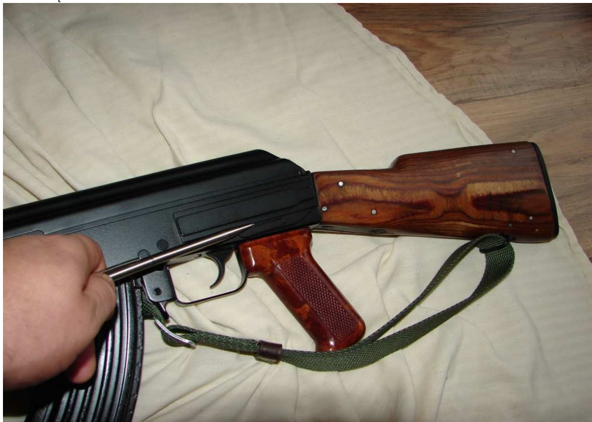
Na zdjęciu widoczna podstawa pod montaż celownika z szyną boczną
