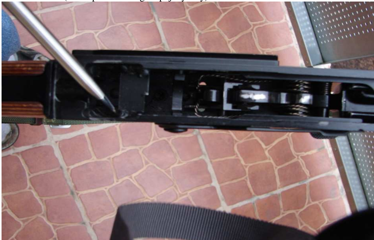
Szyna wspawana w komorze zamkowej
