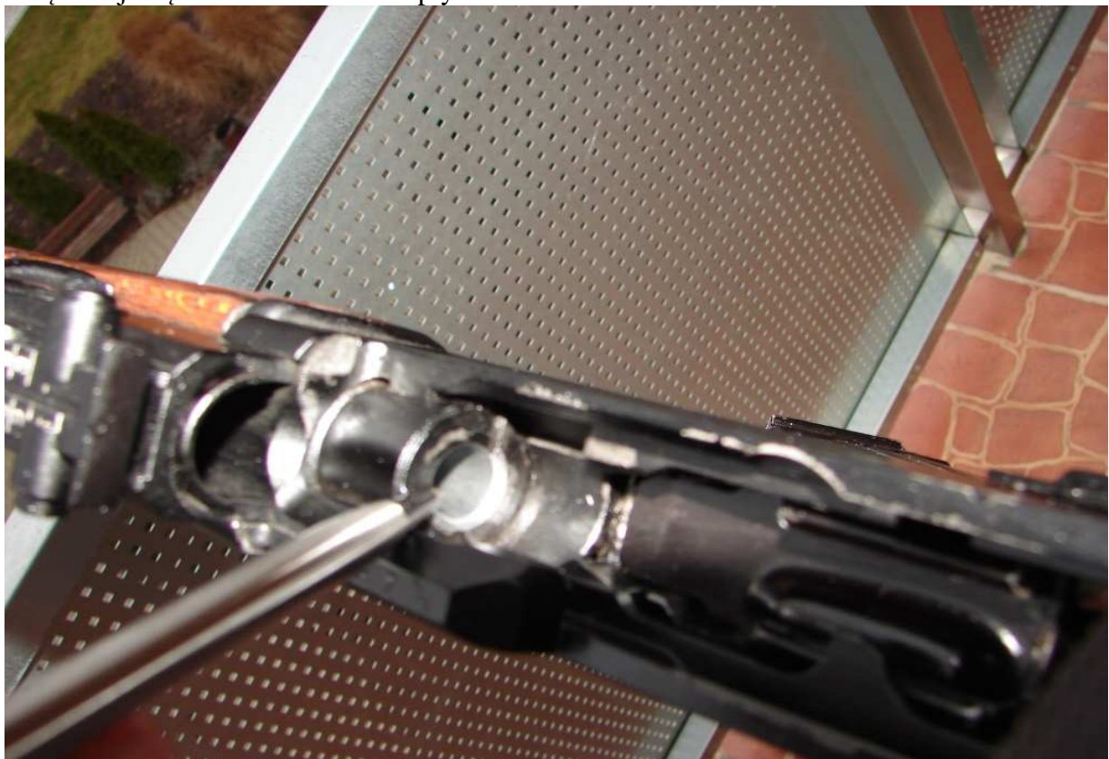
Na zdjęciu widoczna frezowana( masywna) komora naboju
