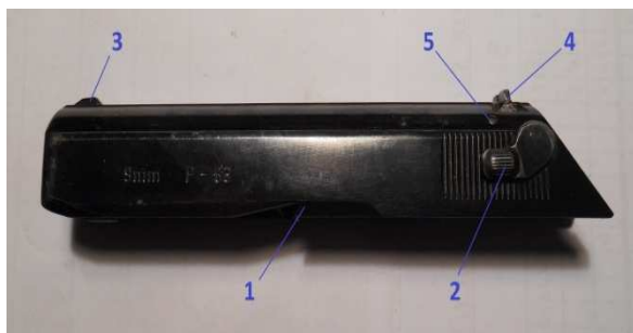
Zamek pistoletu P-83 od strony bezpiecznika
