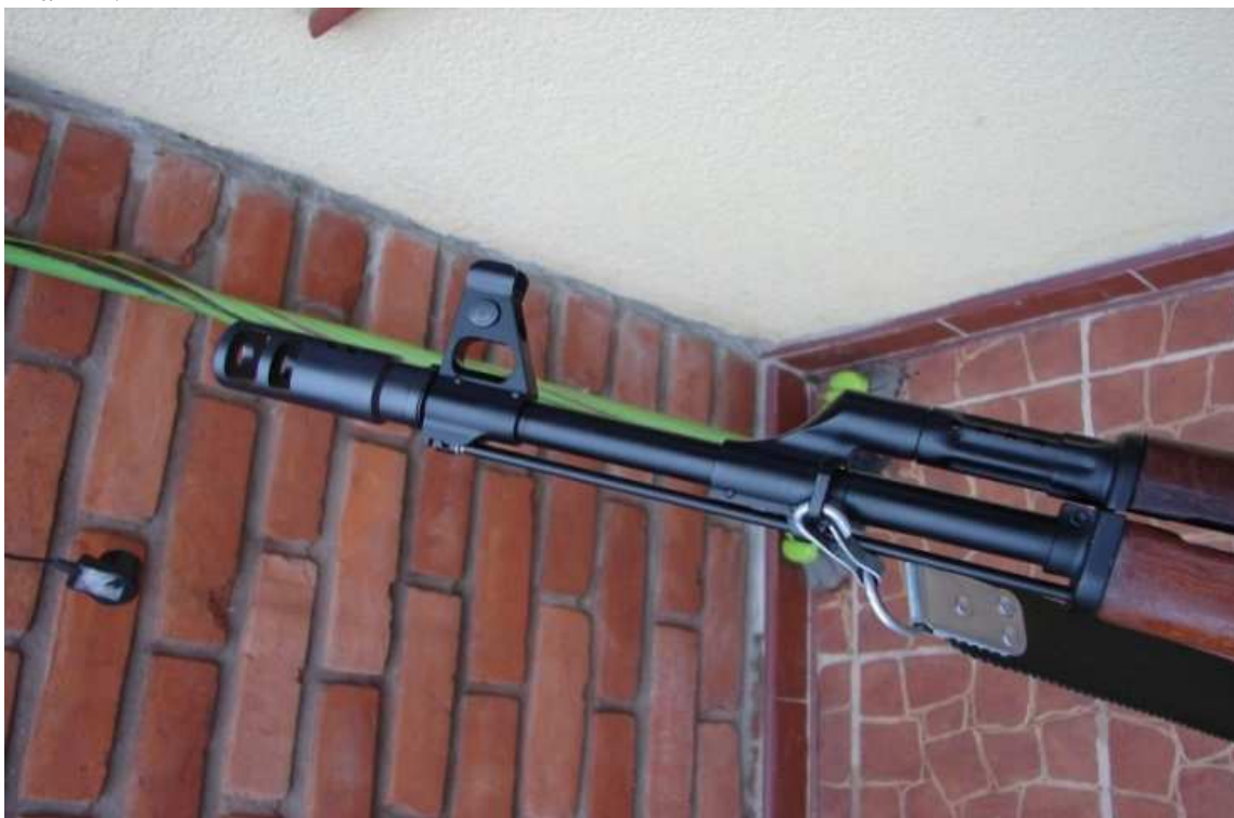
Widok na kompensator odrzutu skonstruowany przez Cerbera (naprawdę świetna rzecz)
