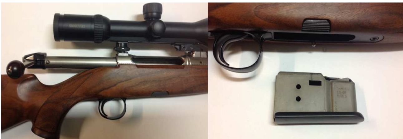
Rys. 7. Otwarta komora zamkowa (widać brak wycięcia w osadzie na rączkę zamka) - z lewej. Magazynek jednorzędowy, metalowy - z prawej.
