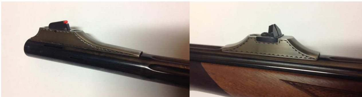
Rys. 5. Standardowe przyrządy celownicze: muszka (widoczne nacięcia magnaportu) i szczerbinka.
