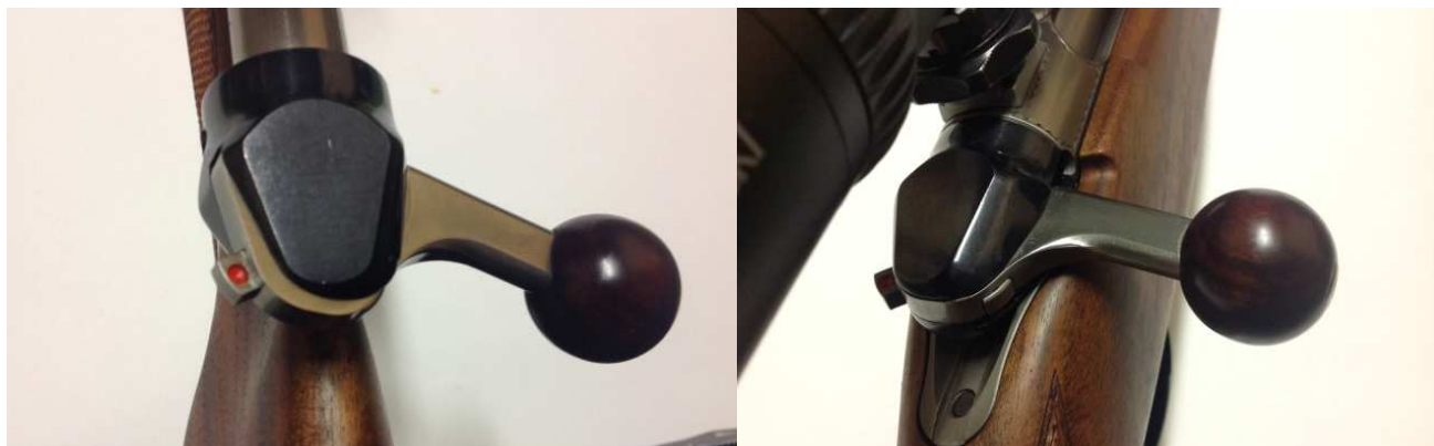
Rys. 8. Zamek w pozycji otwartej, bezpiecznik odbezpieczony - z lewej. Zamek w pozycji zamkniętej, bezpiecznik odbezpieczony, bez napiętej iglicy - bark możliwości oddania strzału - z prawej.
