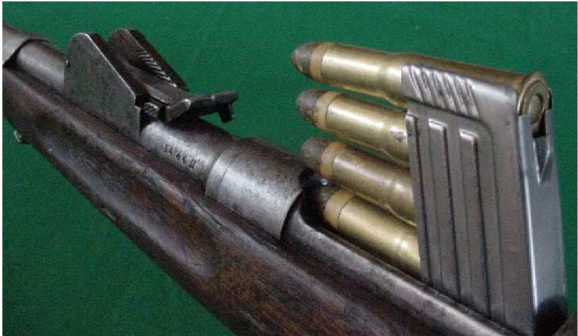
Rys.11 Sposób ładowania za pomocą ładownika z nabojami 11mm
