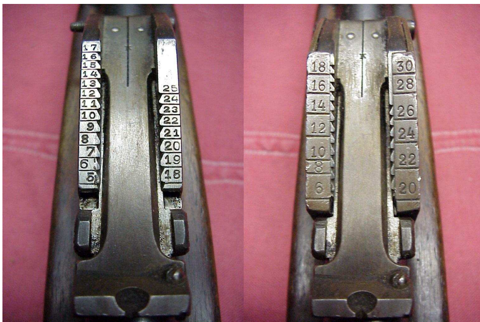
Rys. 12 Modyfikacja przyrządu celowniczego w karabinie M1888 ( z lewej karabin M1888 z prawej M1888/90 z widocznymi nakładkami )
