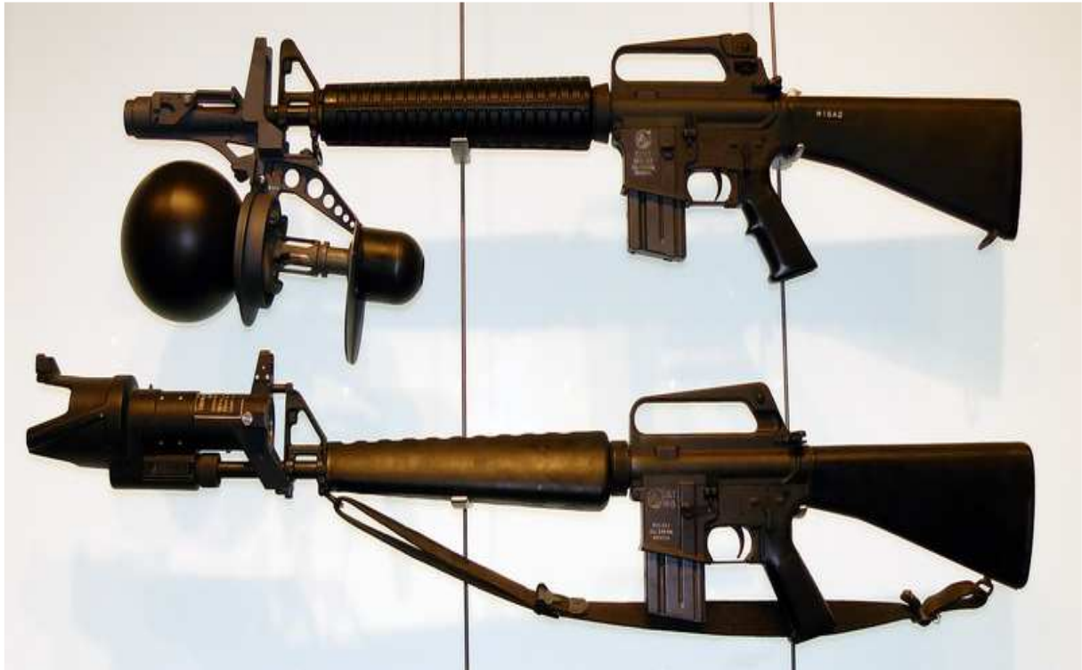
140-mm granat rakietowy Brunswick RBM (Rifleman's Breaching Munition) odmiana rozwojowa Brunswick RAW (Rifleman's Assault Weapon) oraz przyjęta do uzbrojenia, mocowana na M16, wyrzutnia pocisków gumowych M234
