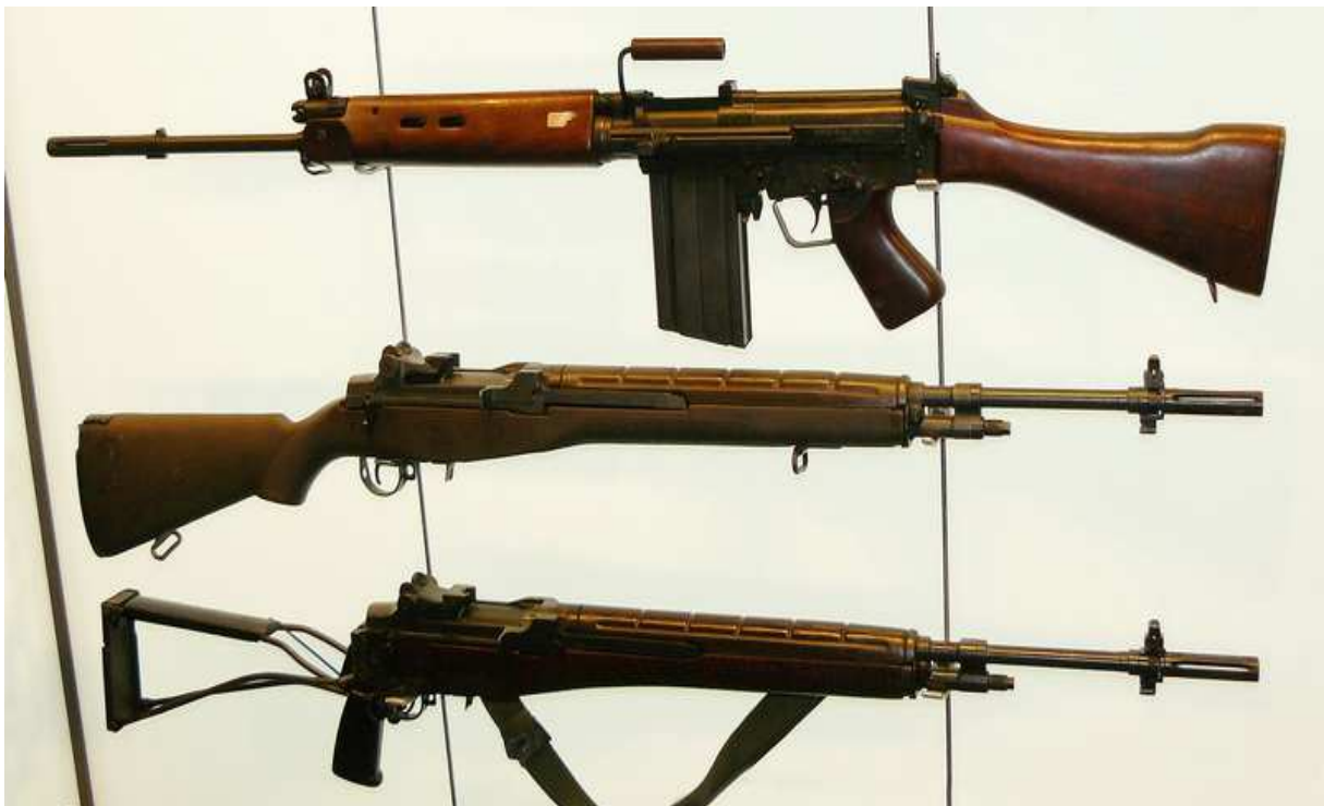
Amerykański karabin T48 (FN FAL) rywalizujący w latach 1950. z T44 (M14) w na nową broń indywidualną armii amerykańskiej, pod nim M14 oraz jedna z odmian M14E1 z kolbą stałą oraz składaną przeznaczoną dla oddziałów powietrzno-desantowych, która nigdy nie została przyjęta do uzbrojenia
