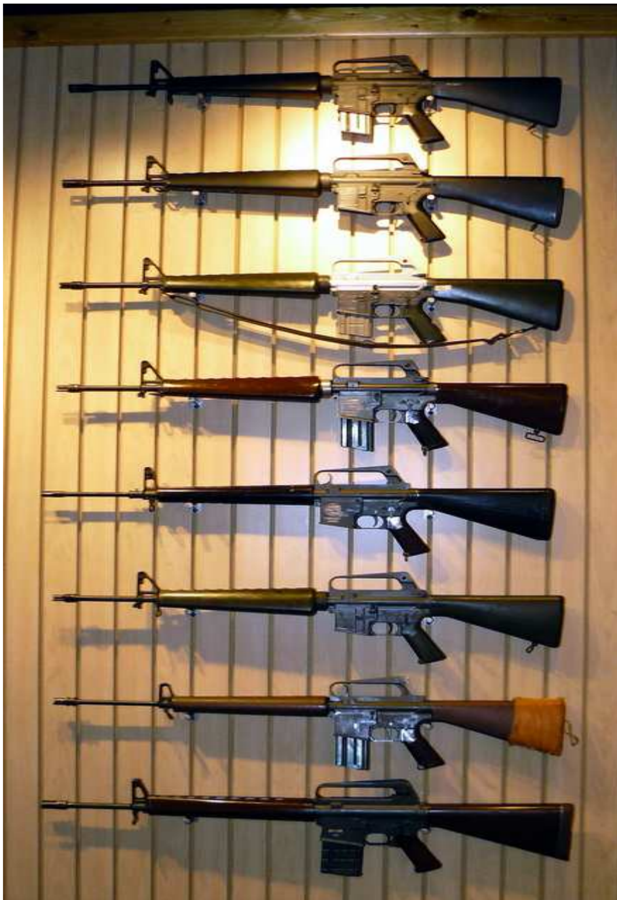
Ściana z najstarszymi modelami AR-15, zaczynająca się od karabinu AR-10A, zaś kończąca na karabinku M16A1. Drugi od dołu to pierwszy model, zaś czwarty to pierwszy prototyp (wówczas jeszcze położenie zabezpieczenia było pośrednim, z skrzydełkiem skierowanym w dół, zaś napinacz znajdował się wewnątrz chwytu transportowego)
