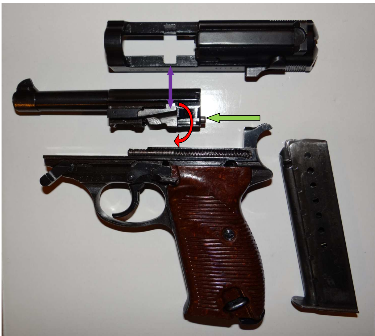
Pistolet rozłożony do czyszczenia. Rygiel w pozycji gotowej do strzału. Czerwoną strzałką przedstawiono kierunek ruchu rygla po oparciu się bolca o szkielet.
