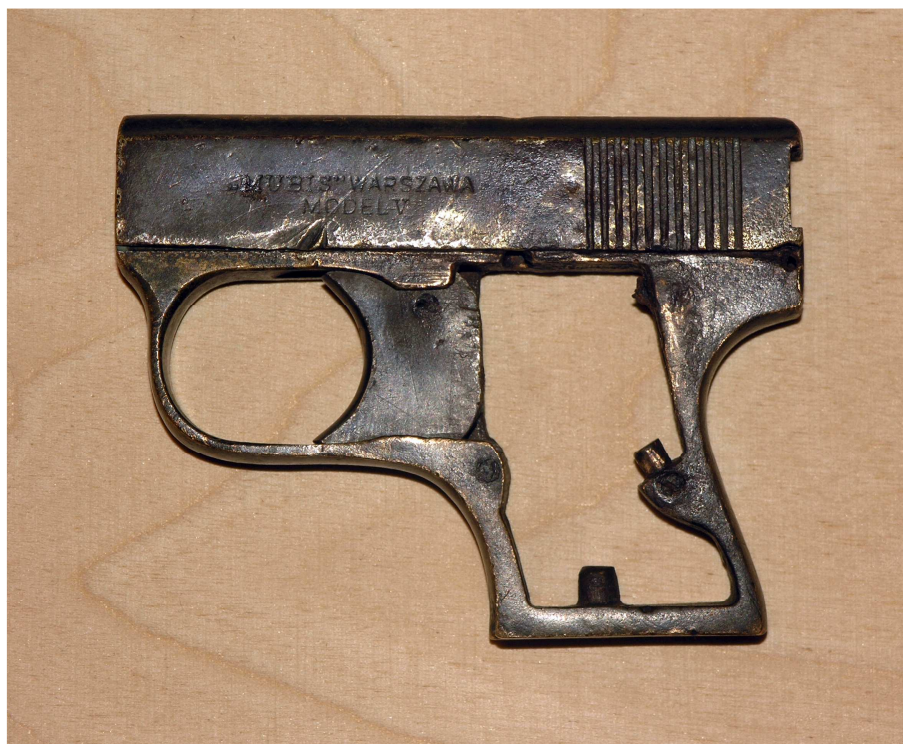
7. Szkielet pistoletu kal. 6 mm Flobert Short, Mod. V, maksymalnie ośmiostrzałowy z automatycznym przesuwem magazynka szufladkowego. Mosiężny, niklowany. Brak mechanizmu, magazynka i okładek. Prod. „Mubis”.
