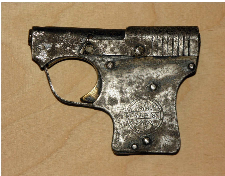
1. Pistolet kal. 6 mm Flobert Short, Mod. Sportowy, jednostrzałowy, z blachy stalowej wytłaczanej i pierwotnie malowanej czarną farbą olejną (zachowały się wyłącznie jej relikty). Prod. „Mubis”.
