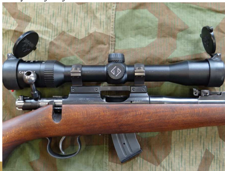
Zdjęcie 6. Część środkowa broni. Zamek w tylnym położeniu.
